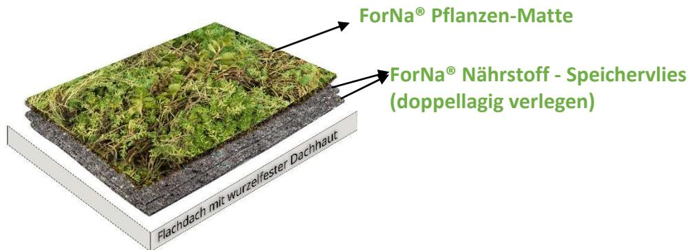
1. Dachfläche ist bauseits mit einer wurzel- und wasserfesten Dachfolie ausgestattet (falls nicht können Wurzelschutzfolien bei uns angefragt werden)
